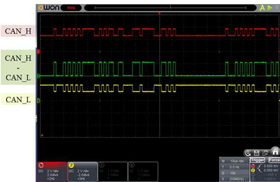
Fig. 9. CAN signal waveform measured on oscilloscope 그림 9. 오실로스코프에서 측정된 CAN 신호 파형
