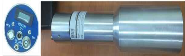
Fig. 2. NaI(Tl) Detector + PMT 그림 2. NaI(Tl) 검출기 + PMT
