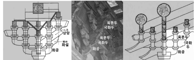
그림 6. 작: 송 『영조법식』의 상양식 두공 / 중: 녕덕전 실내 두공 / 우: 남암궁 현제전의 두공 일부본
