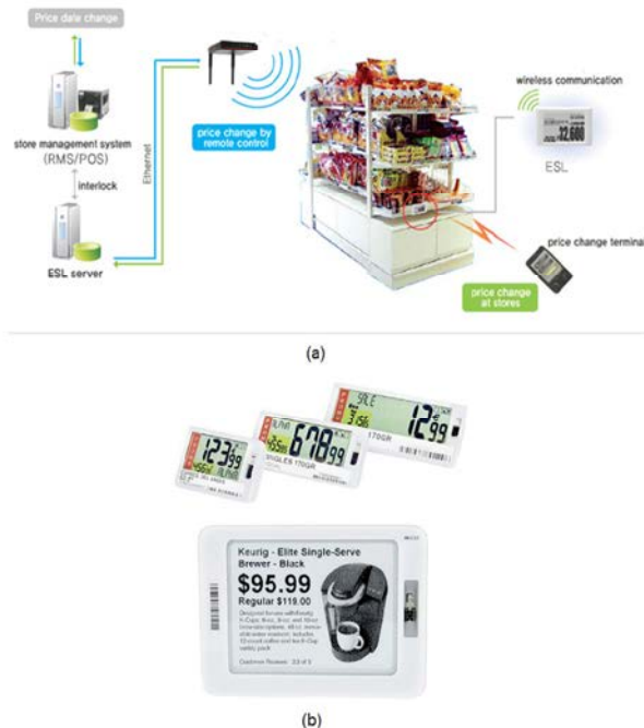
그림 4. 전자가격표시기(ESL): (a) 전자가격표시 시스템, (b) 전자가격표시기
