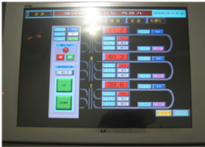
그림 4. 도체 온도, 표면온도 변환장치 표시화면 Fig. 4. Screen of device for converting conductor temperature into surface temperature
