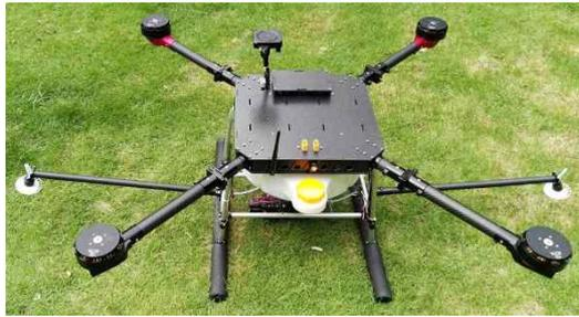
[Fig. 3] Quadrotor UAV
