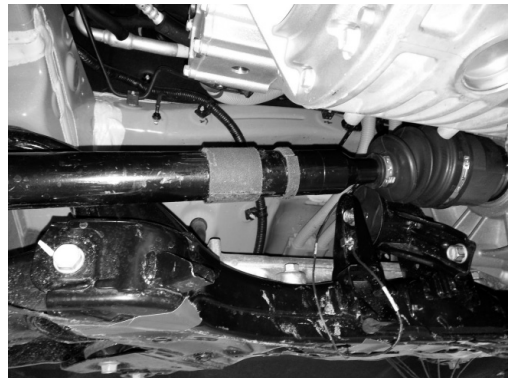
그림 5. 드라이브 샤프트 수동형 패치 부착 Fig. 5. Passive Damping Patch Attached on Drive Shaft of Electric Vehicle.
