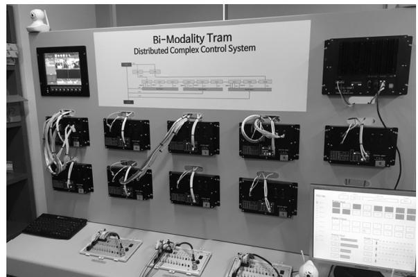
그림 7. 시험 환경 사진: 시험 치구 및 각 구성요소 (COU, DIU, TOU, CCTV)
