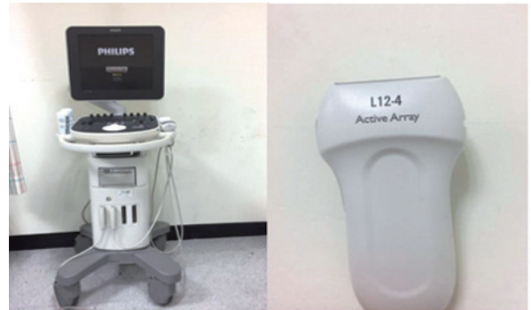
〈그림 2〉 일반적으로 의료분야에 사용되는 실제 초음파 장비와 프로브 (선형 프로브, linear probe)
