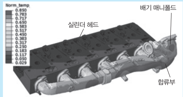
그림 4 엔진 실린더 헤드와 배기매니폴드 온도분포(Seifert et al., SAE Int. J. Mater. Manf. Vol. 7, Iss. 2, 2014 논문에서 인용)
