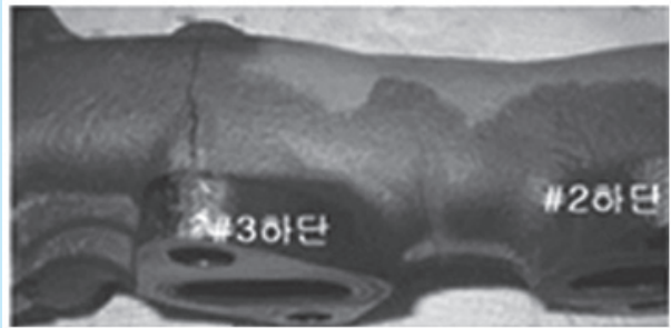
그림 2 배기매니폴드 파손(최복록 등, 한국자동차공학회지, Vol. 18, No. 6, pp. 7-13, 2010 논문에서 인용)
