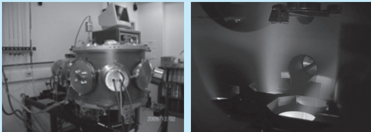
그림 3 스퍼터링 공정 시스템과 플라즈마 발생(예)
