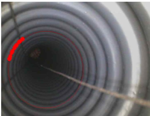
Fig. 8 Edge detection by using edge strength
