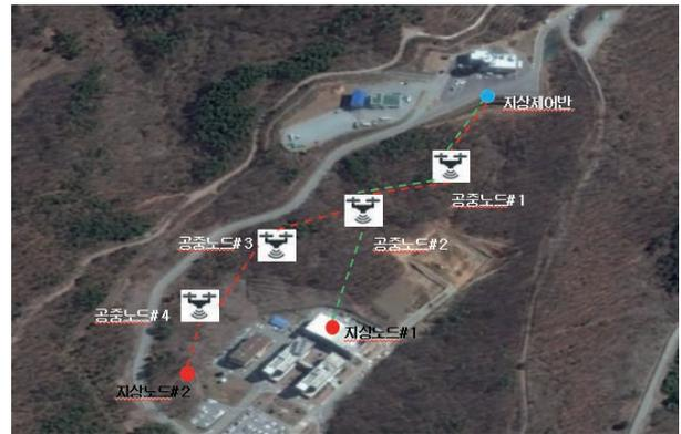
〈그림 13〉 공중멀티홉 구성 실환경 시험
