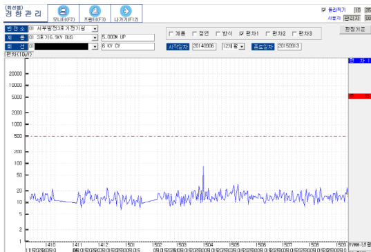
그림 1. No.01 feeder의 누설전류의 표준편차 trend 1 Fig. 1. Standard deviation trend 1 from the leakage current of No.01 feeder
