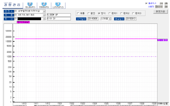
그림 3. No.01 케이블의 12개월간 방식층 절연저항 1일 측정 data의 trend Fig. 3. Measured record insulation resistance of No.01 feeder in 12 months (daily data)
