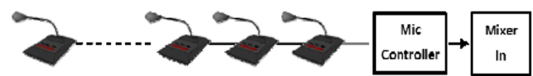
그림 3. 회의용 마이크장비의 오디오 신호전달 Fig. 3. Audio Signal Transmission of Conference Microphone Equipment
