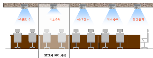
그림 11. 믹스 마이너스 방식으로 음성 확장 Fig. 11. Audio Amplification though Mix Minus System
