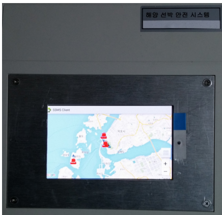
Fig. 9. Indication of location for the nearby vessels 그림 9. 주변 선박의 위치 표시
