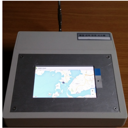
Fig. 6. The safety equipment for small-size vessel 그림 6. 소형 선박용 안전장치
