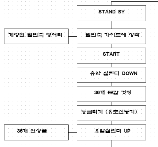
그림 4. 작동 순서도 Fig. 4. Operating Sequence Diagram.
