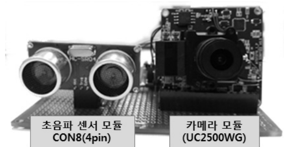
그림 7. 신장인식 초음파 모듈과 CCD 카메라 모듈 Fig. 7. Ultrasonic Module and CCD Camera Module.
