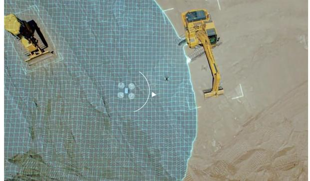
그림3. Skycatch사의 드론을 이용한 지형스캔
