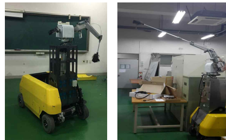
텔레스코픽 마스터 로봇을 이용한 사과인공수분 복지로봇 개발 시제품
