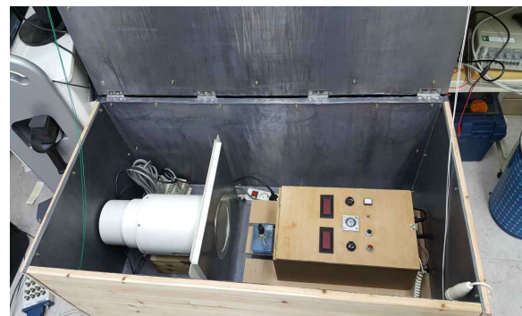
그림 6. 영상획득 H/W 시스템의 하우징 Fig. 6. H/W system housing of image acquisition.
