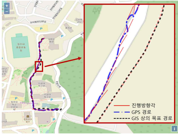
그림 9. GIS상에 표시된 계획경로, 진행경로와 진행 방향 실험 결과 Fig. 9. Experimental results of scheduled path, GPS path and pose direction
