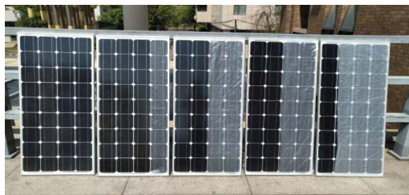
Fig. 24. PV string under cell-level PSC.
