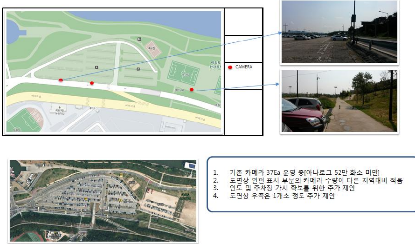
〈자료 4-2〉 CCTV 카메라 추가 설치 위치(권고)
