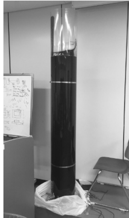
그림 1. 초음파 소자 측정 실험을 위해 제작한 탱크와 원유 샘플
