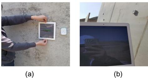
그림 5. 스마트 안전 계측 시스템의 필드 테스트 환경: (a) 직벽식 프리캐스트 옹벽, (b) 2부벽식 프리캐스트 옹벽
