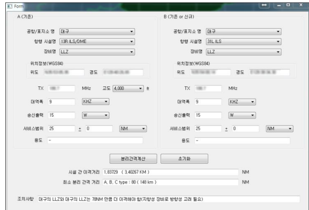
그림 4. LLZ간의 분리간격 분석 Fig. 4. Analysis of separation distance between LLZ.
