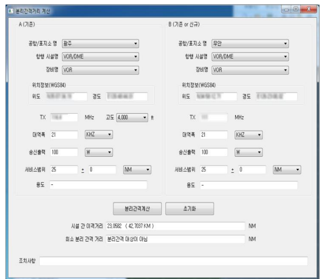
그림 3. 장비/시설간 지리적 분리간격 분석 Fig. 3. Analysis of geographical separation distance between aids/facilities.
