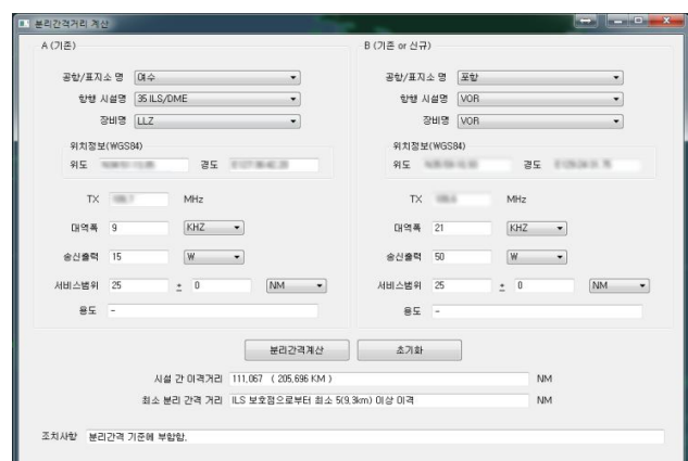
그림 6. LLZ와 VOR간의 분리간격 분석 Fig. 6. Analysis of separation distance between LLZ to VOR.
