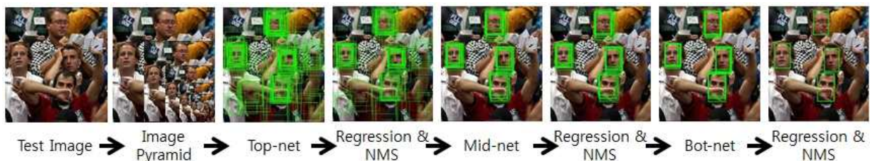
Fig. 4. Pipeline of Our Cascade CNN 그림 4. 본 시스템의 Cascade CNN 파이프라인
