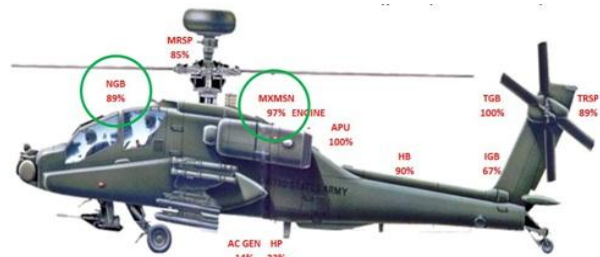
그림 5. 아파치 헬리콥터 HUMS 임계값 초과 시 정비수행 결과 Fig. 5. Result of inspection and repair on Apache helicopter using HUMS.
