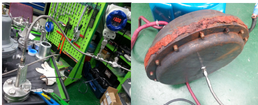
Fig. 7 O-RING 및 Diaphragm 노화 후 압력시험
