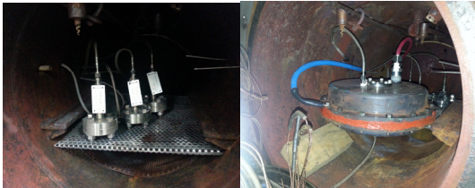
Fig. 6 O-RING 및 Diaphragm의 DBE시험
