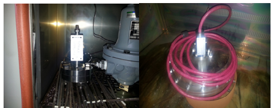
Fig. 5 O-RING 및 Diaphragm 열적노화시험
