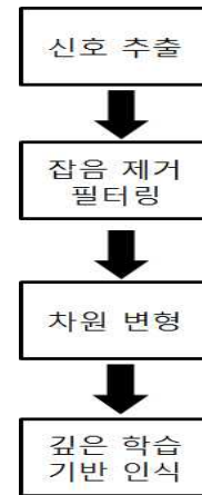
그림 3. EPS 동작신호 인식 시스템의 구성도
