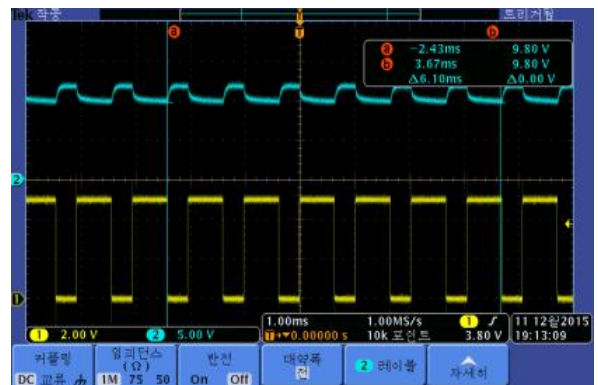
그림 21. 통전 62% PWM 제어파형(Ch1), LED 출력파형(Ch2) Fig. 21. PWM wave and LED output wave at duty 62 %.
