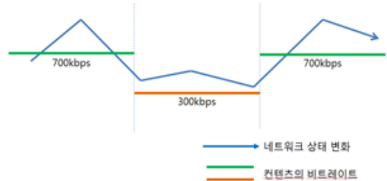
(그림3) 통신망 상태변화에 따른 적응 비트 율 스트리밍 적용 (Fig. 3) Adaptive bit-rate streaming with network
