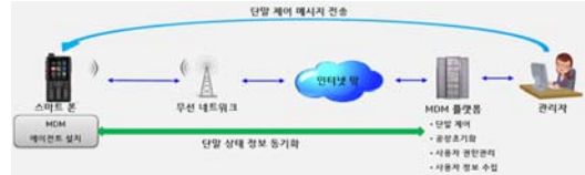
[그림 10] PS-LTE 보안성 시험환경/MDM구성도 분석
