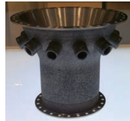
〈그림 4〉 프린팅 → CNC가공(터빈케이스-스테인레스강)
