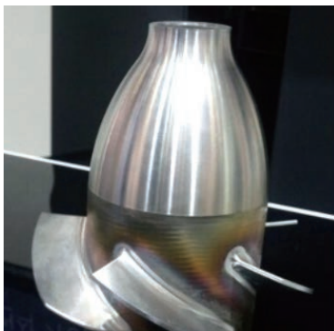
〈그림 10〉 DMT 장비에서 제작된 제품(금속프린팅 → CNC가공)
