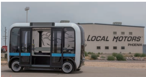
〈그림 5〉 3D 프린터에 의한 외형제작
