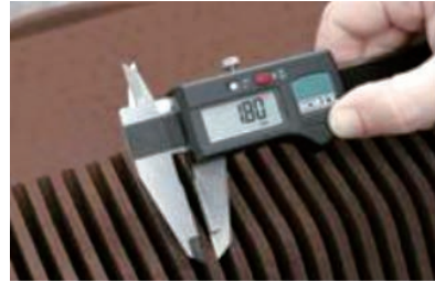
〈그림 3〉 3D프린터를 이용한 주조 샌드몰드제작(독일AC테크)
