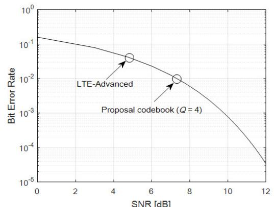
그림 8. MMSE 검출방식에 의한 BER 성능 (QPSK 변조)
