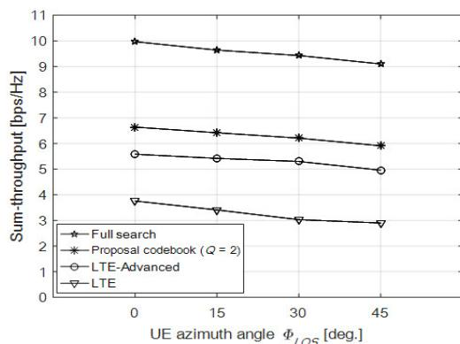
그림 6. 단일 편파 구조 송신안테나에서 단말의 방위각  $\Phi_{LOS}$ 에 따른 코드북 성능평가
