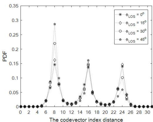
그림 4. 단일 편파 송신안테나에서 단말의 방위각  $\Phi_{LOS}$ 에 따른 전체탐색 방식의 레이어간 코드벡터 인덱스 간 상대적 거리의 확률밀도함수
