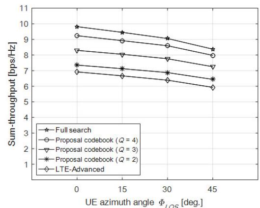
그림 7. 교차 편파 구조 송신안테나에서 단말의 방위각  $\Phi_{LOS}$ 에 따른 코드북 성능평가
