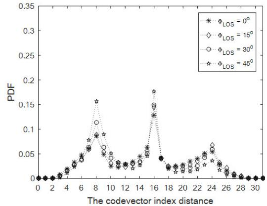
그림 5. 교차 편파 송신안테나에서 단말의 방위각  $\Phi_{LOS}$ 에 따른 전체탐색 방식의 레이어간 코드벡터 인덱스 간 상대적 거리의 확률밀도함수
