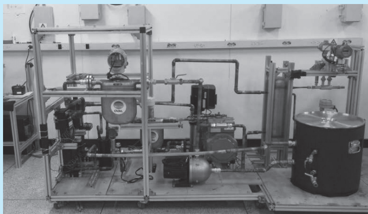
그림 5 국내 대학에 설치된 스팀히트펌프 실험장치
