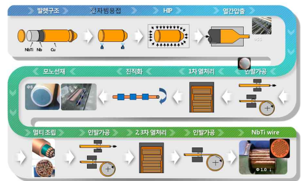
그림 4. NbTi 초전도 선재 제조과정.
