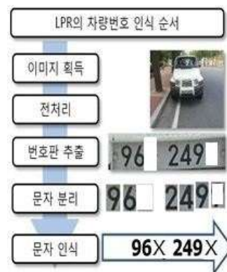
그림 1. 번호판 인식 과정 Fig. 1. Procedure of license plate recognition.
