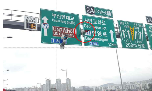
그림 6. 도로상의 구조물에 설치된 스테레오 카메라 Fig. 6. Installed stereo camera at a gantry on a road.
