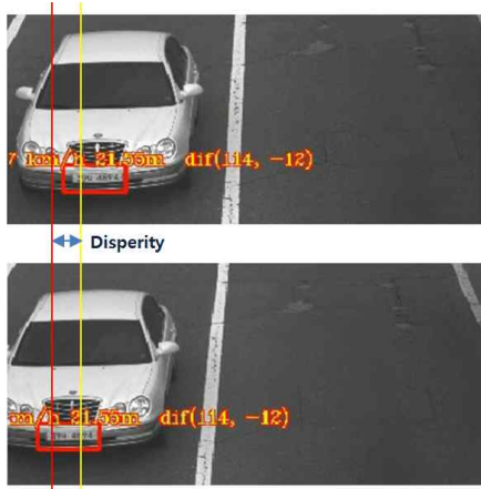
그림 2. 스테레오 좌우 영상의 양안 차 Fig. 2. Disparity of a stereo image.
