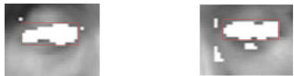
그림 7. 레이블링을 위한 후보 픽셀 및 눈 영역외 에지를 제거하기 위한 검출된 영역 Fig. 7. Candidate pixels for labeling operation and Detected region in order to remove edges on the outside of the eye.
