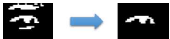
그림 8. 눈 영역에서의 에지 이미지(왼쪽)과 눈 외 영역의 에지 제거한 에지 이미지(오른쪽) Fig. 8. Edge image in eye region(Left) and Edge image without the rest of edge which excepts eye region(Right).
