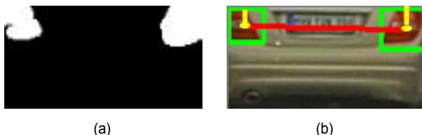
그림 7. (a) 검출된 후미등 블롭 (b) 유클리디언 척도를 이용한 후미등 검증 Fig. 7. (a) A result of candidate blob detection (b) Tail-light verification with Euclidean distance
