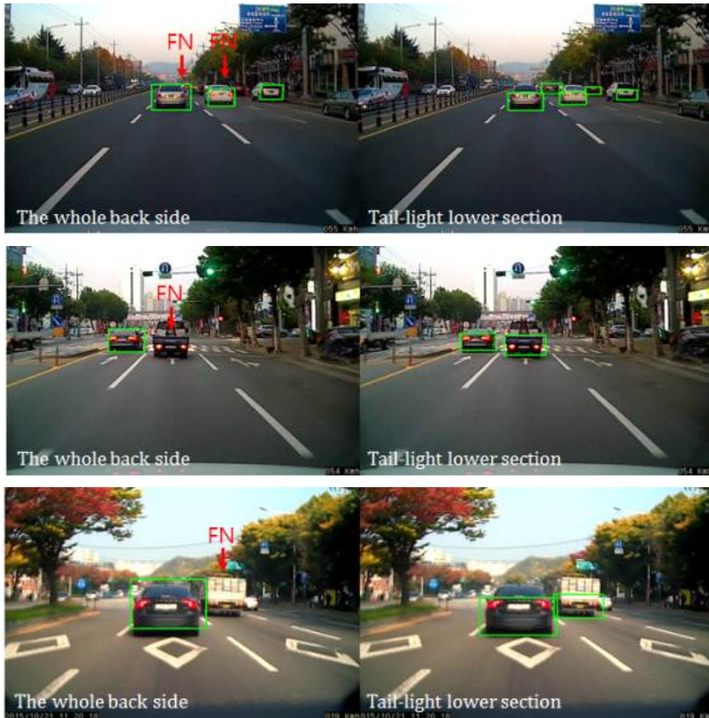
그림 10. 후면 전체 학습과 후미등 하단 부 학습 기반의 자동차 검출 결과 Fig. 10. A result of training whole vehicle back side and tail-light lower section
