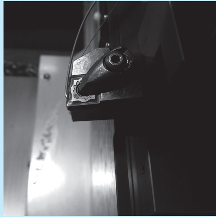
그림 8 초경 인서트에 삽입된 열전대와 경사면에 조사된 레이저의 모습
