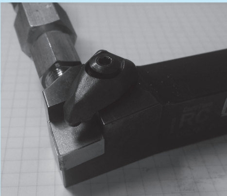
그림 5 스테인리스스틸 챔버를 포함하는 개발된 간접냉각방식 공구홀더
