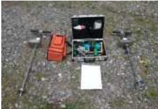
그림 2. 토양물리성 측정장치 (SR-2 type) Fig. 2. Soil Physical measurement device (SR-2 type)
