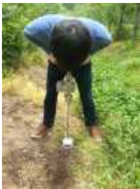
그림 5. 전단특성 측정 Fig. 5. Measuring Shear Properties
