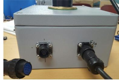
그림 4. 제안하는 부이 시스템의 커넥터 구성
