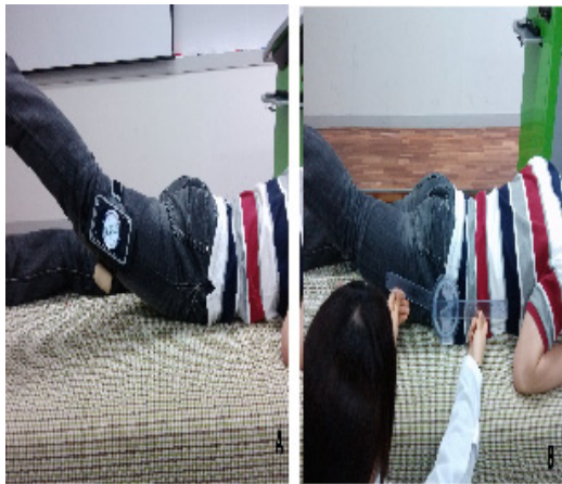
그림 3. Hip extension 측정 A: 스마트폰 경사계, B: 고니오미터
