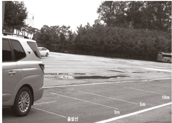
그림 5. 차량 후진 주행속도 측정 실험사진
