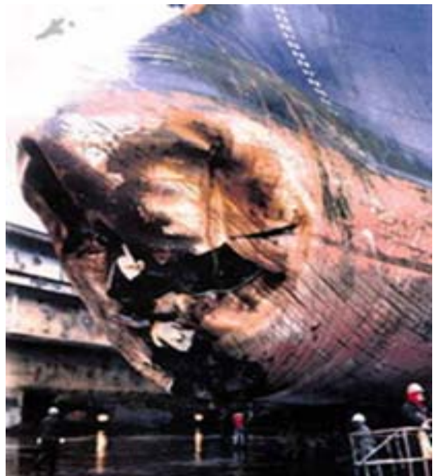
그림 1 Damaged bow structure by ice collision
