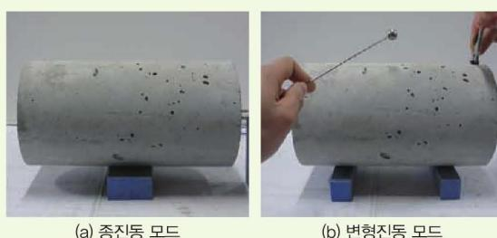
그림 5. 충격공진시험 전경
