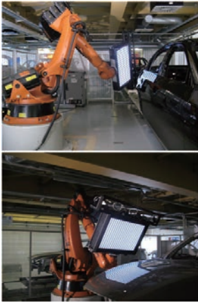
〈그림 8〉 차량 표면 형상 검사 [7]
